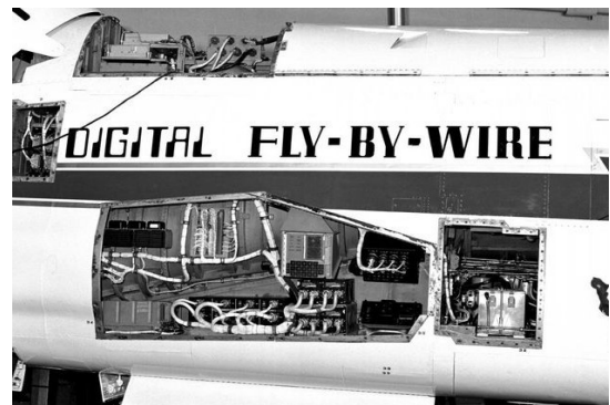
Fly-by-Wire-System 1972 in einer Vought F-8 der NASA (Quelle: de.wikipedia.org/wiki/Fly-by-wire )
